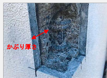
はつり調査及び鉄筋のかぶり厚さ
