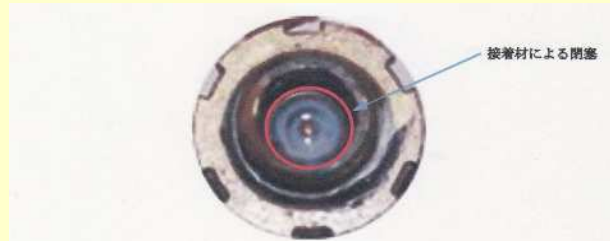
図2 スプリンクラーヘッドの内部で固着した接着剤(白色部分)
