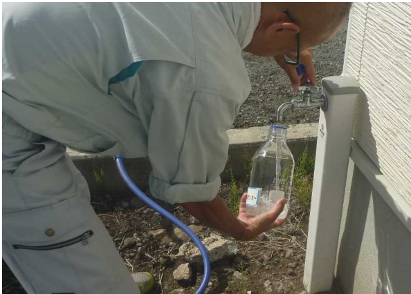
水質検査のための採水
