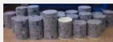
採取したコンクリートコア
