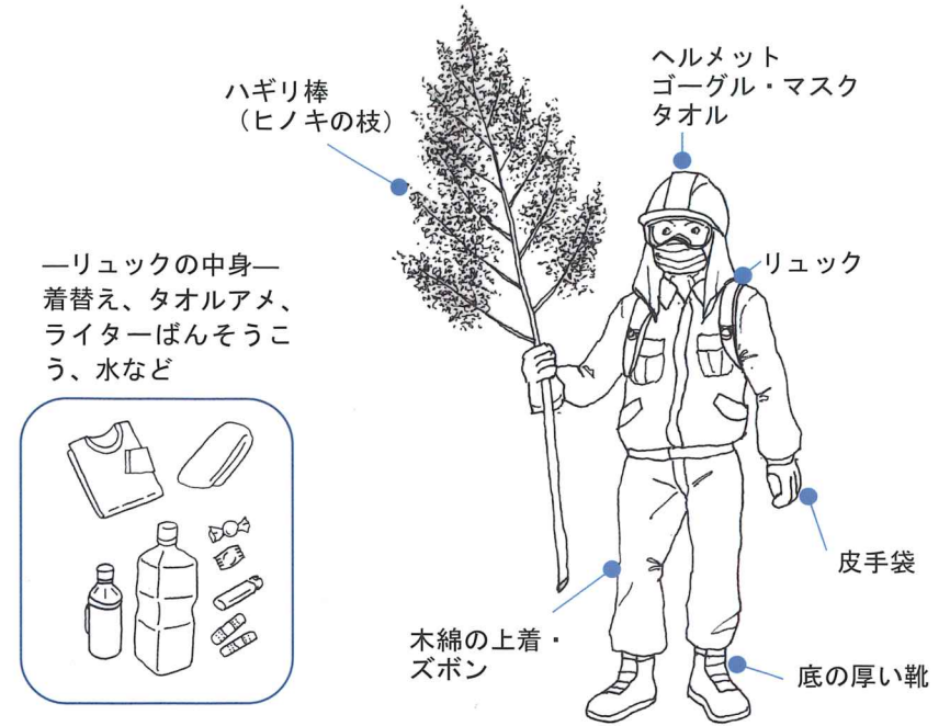
図 5-1 火入れの服装・装備
