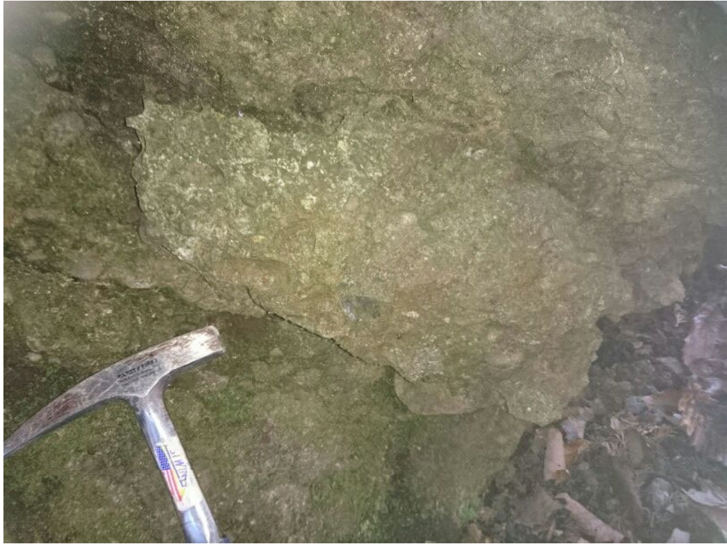
写真 4-6-30 写真-29 の接写 (φ20mm 大の円礫を含む礫岩)
