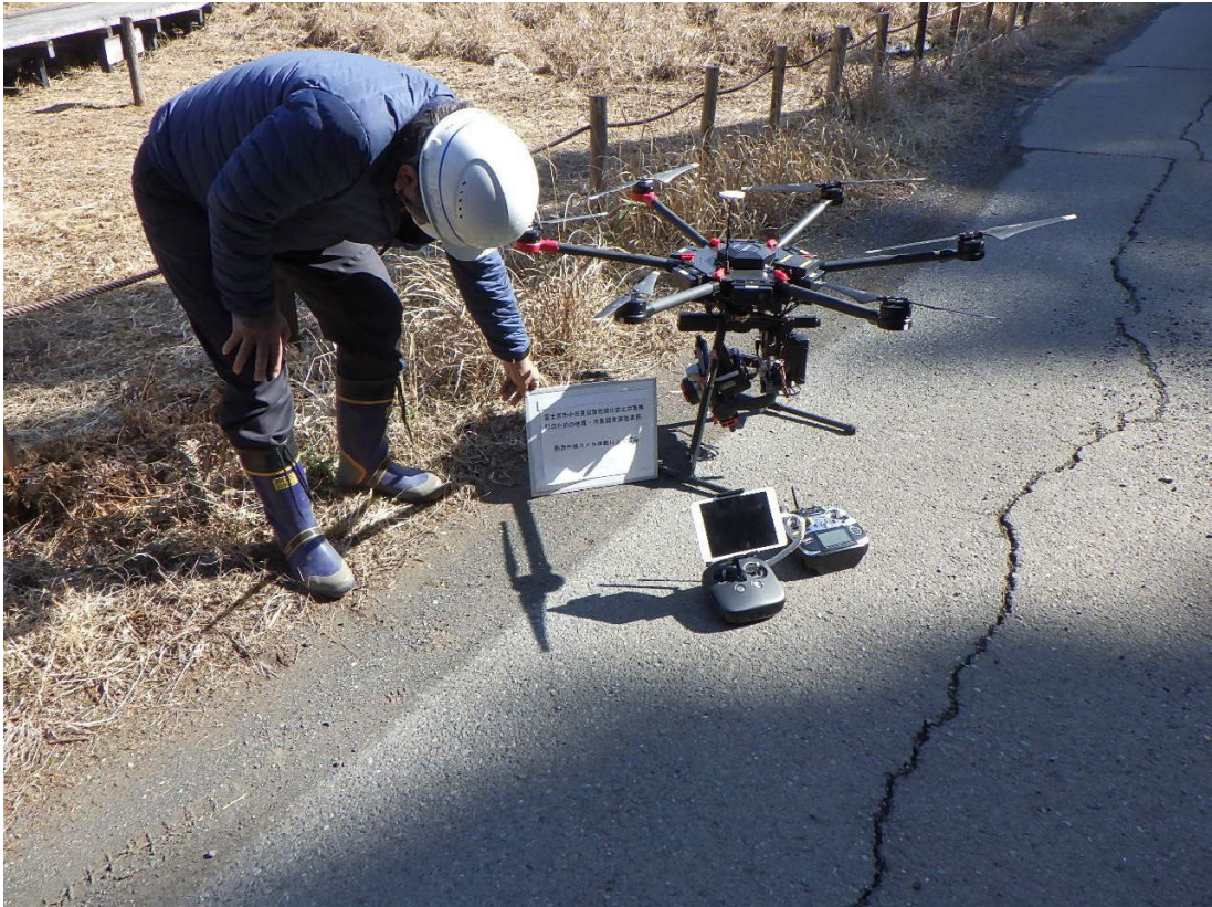
写真 15-1. 赤外線カメラ搭載 UAV 機器一式
