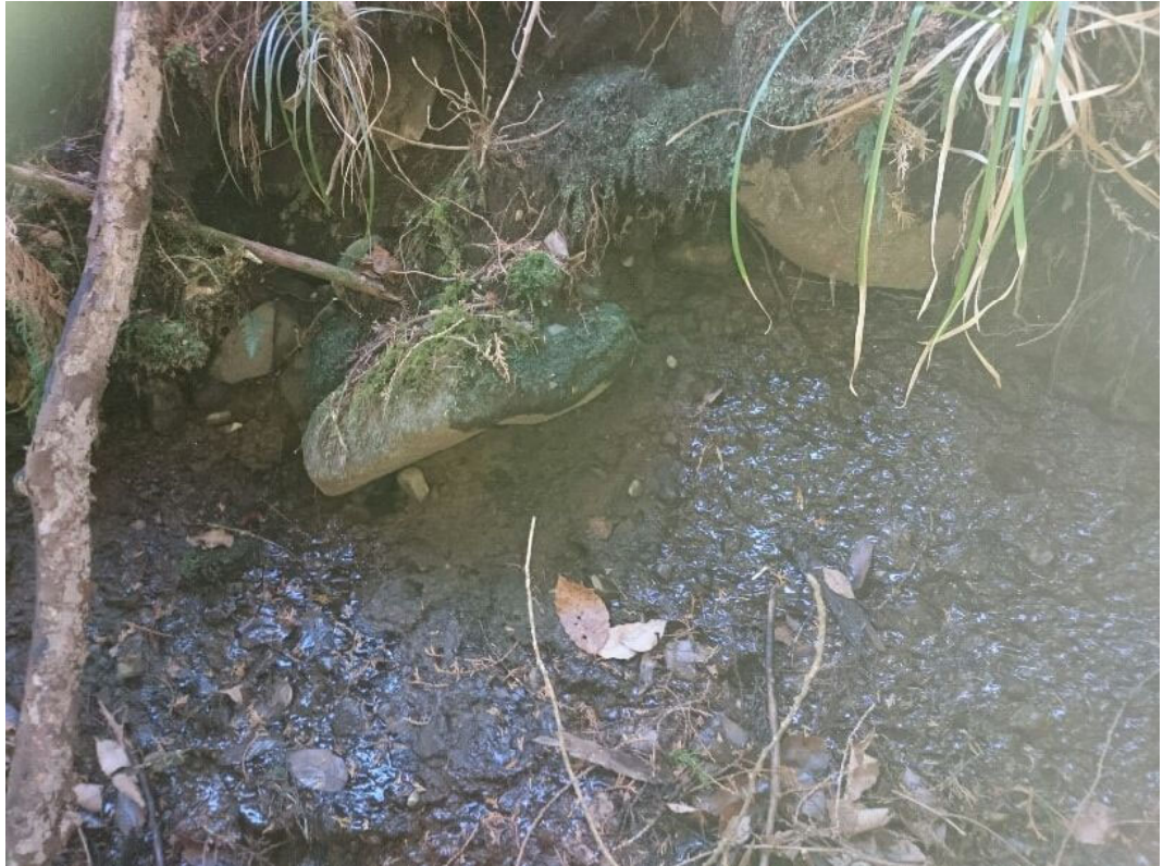
写真 4-6-36 スゲノ沢河床堆積物とみられる玉石混じり砂礫（湧水） 下位層は田貫湖岩屑なだれ層（角礫で基質は固結してハンマー打撃でも崩れない）
