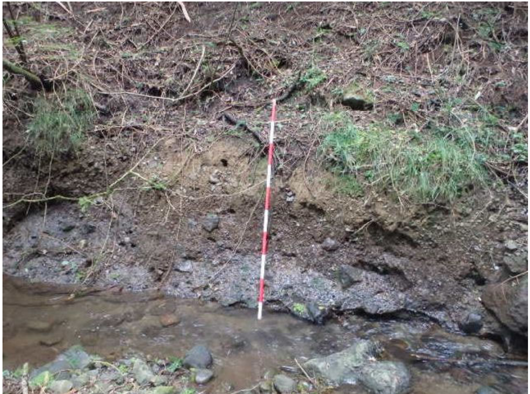
写真 4-6-27 最下位層は田貫湖岩層なだれ層？ (H-Tnk：古富士泥流)；固結性高い
