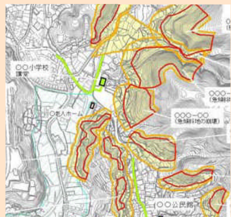
マップの例 黄色：土砂災害警戒区域 赤色：土砂災害特別警戒区域
